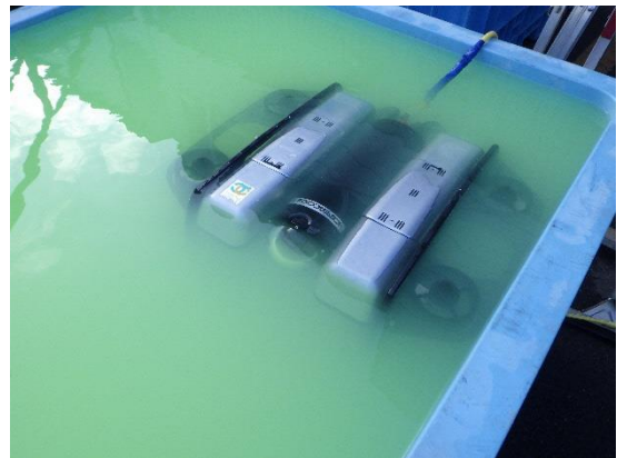
濁水中に入れた水中ドローン
